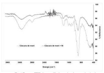
Fig. 1 Espectro FTIR de cascarilla de maní cruda con y sin níquel
