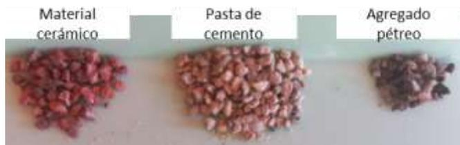
Figura 2b. Imagen de las fracciones del material adsorbente
