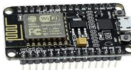
Fig. 4. Módulo WiFi NodeMCU ESP8266
