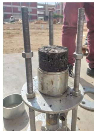
Fig. 3. Briqueta diseñada para tránsito pesado
