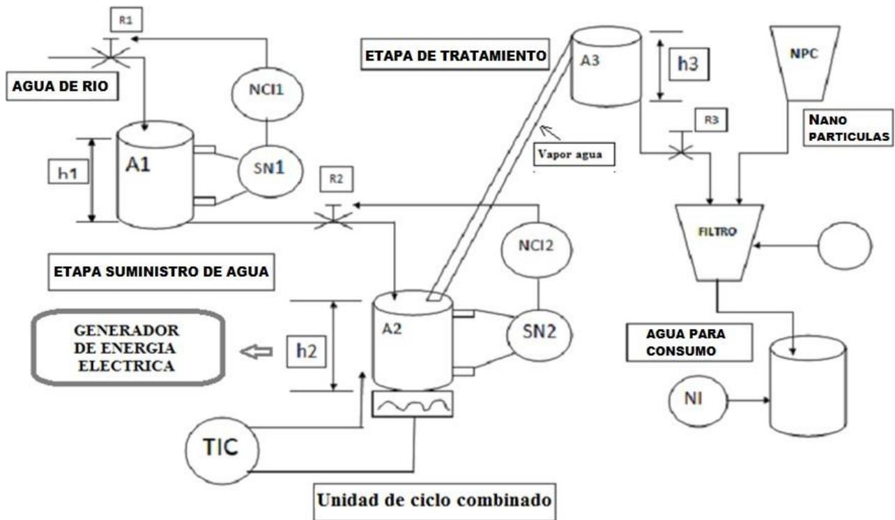
Figura.7. Sistema de control de generación de energía termoeléctrica mediante tratamiento de agua de río
