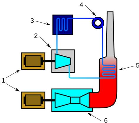
Figura 1. Esquema del funcionamiento de una central de ciclo combinado
