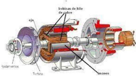
Figura 3. Generador a turbina de vapor
