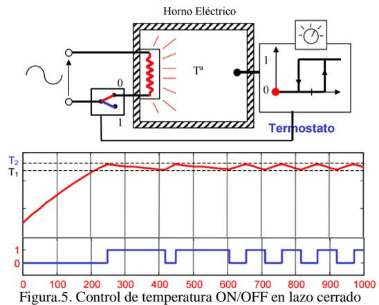
Figura.5. Control de temperatura ON/OFF en lazo cerrado
