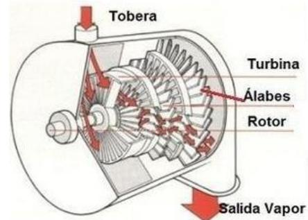
Figura 2. Turbina a vapor de agua
