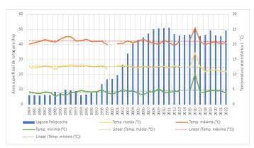
Fig. 3: Comparativo entre evolución de la extensión de la laguna Palcacocha y el promedio anual de temperaturas de la estación meteorológica Recuay.
