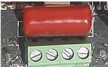
Fig.9 Capacitor para crear la onda sinusoidal.
