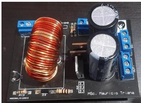
Fig.14 Convertidor elevador DC-DC
