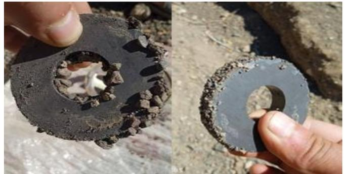
Fig 1. Agregado natural que contiene partículas hierro (MH). Las partículas de hierro son atraídas por magnetismo al imán [20]
