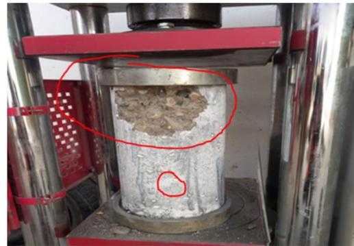
Fig. 4 Rotura de especímenes a los 28 días
