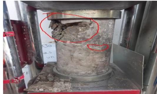
Fig. 3 Rotura de especímenes
