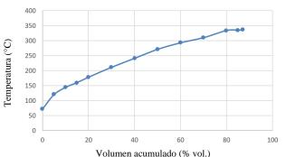
Fig. 5 Curva de destilación de producto liquido
