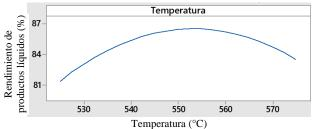
Fig. 2 Efecto de la temperatura en el rendimiento de productos líquidos
