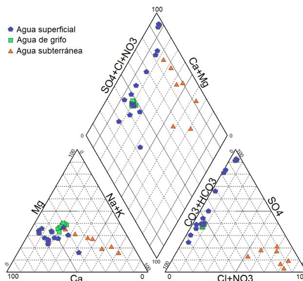
Fig. 4 Diagrama de Piper de la composición hidroquímica de las aguas superficiales, aguas de grifo y aguas subterráneas.
