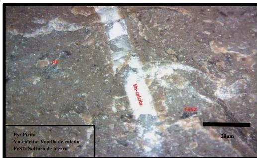
**Figura 2:** Fotomicrografía de muestra de caliza con presencia de sulfuros de hierro, venillas de calcita, pirita diseminada (Fuente propia)
