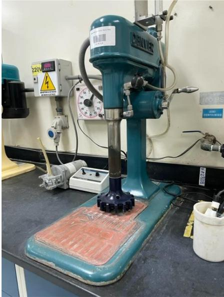
Figura 11. Celda de Flotación Denver.
