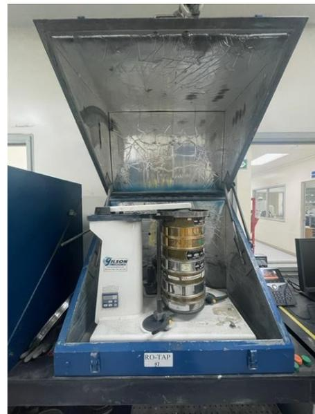
Figura 13. Equipo ROT-UP, utilizando mallas ASTM.
