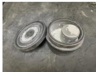
Figura 7. Olla de pulverizado.
