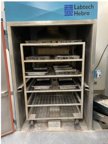
Figura 4. Horno de secado de mineral.
